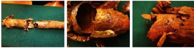
图9 事故管道腐蚀断裂实物
